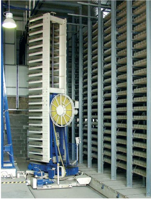
كما تتميز بأسطح دسارية ذات مداخل جانبية، وخاضعة لعملية جلفنة خاصة.
