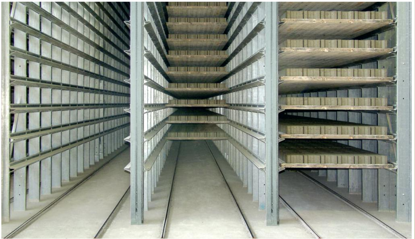
تتميز غرف الصلادة التي تقدمها شركة HS Anlagentechnik بأنها دقيقة الحجم والقياس فضلاً عن كونها ثابتة متوازية.
