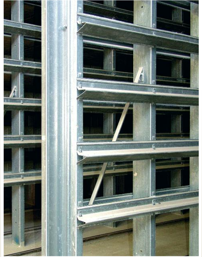
إدخال وإخراج آمن من خلال عربات السحب وكذلك الفتحات العميقة الموجودة على الجوانب والتي تمنع ارتطامها بالأسطح والطبقات الفولاذية.
