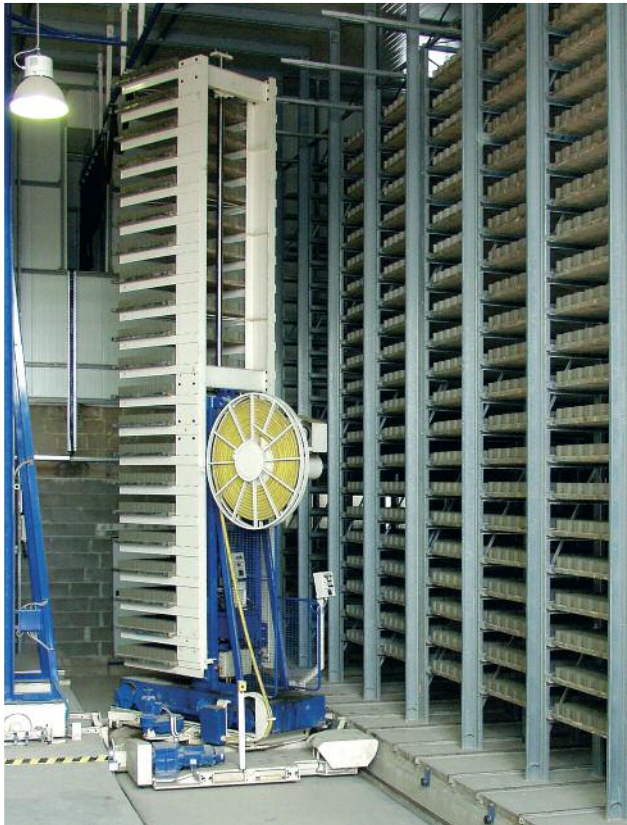
Sichere Ein- und Auslagerung durch den Absetzwagen – die hochgezogene seitliche Sicke des Auflageprofils verhindert das An-schlagen an die Stahlständer.
