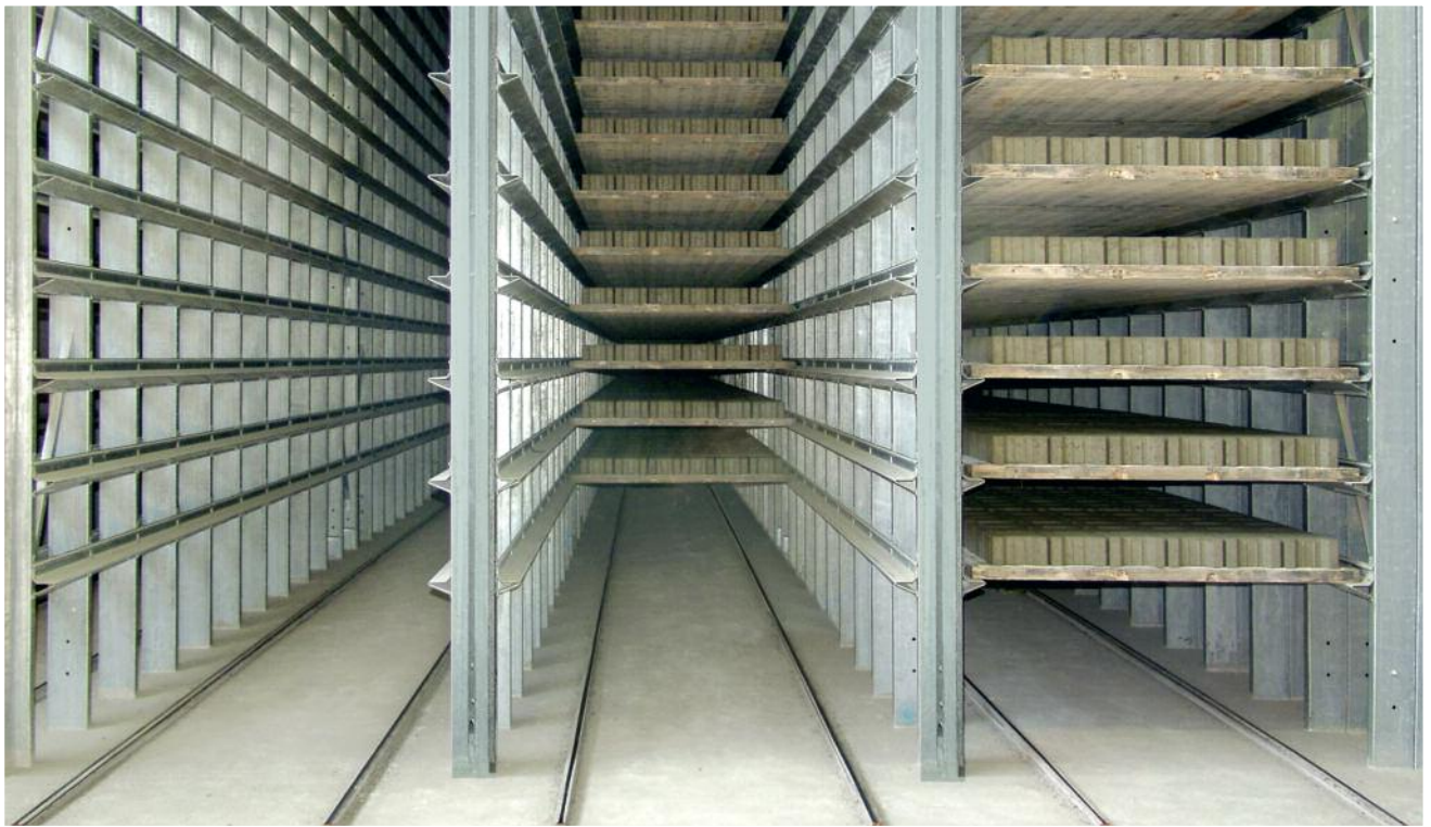
Härtekammern von HS Anlagentechnik zeichnen sich durch höchste Maß- und Passgenauigkeit, Parallelität und Stabilität aus.
