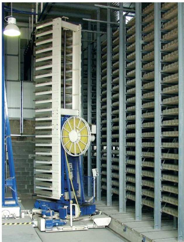
Almacenaje y extracción seguros a través del carro depositador – la acanaladura del perfil de apoyo levantada lateralmente impide que se golpee contra las columnas de acero.
