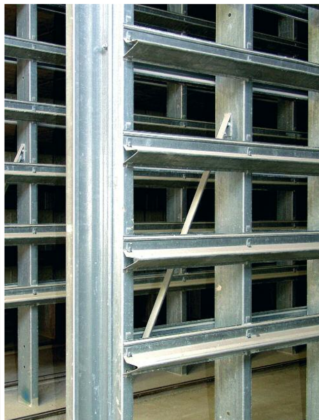
Profilati di appoggio con guida laterale continua e zincatura speciale.
